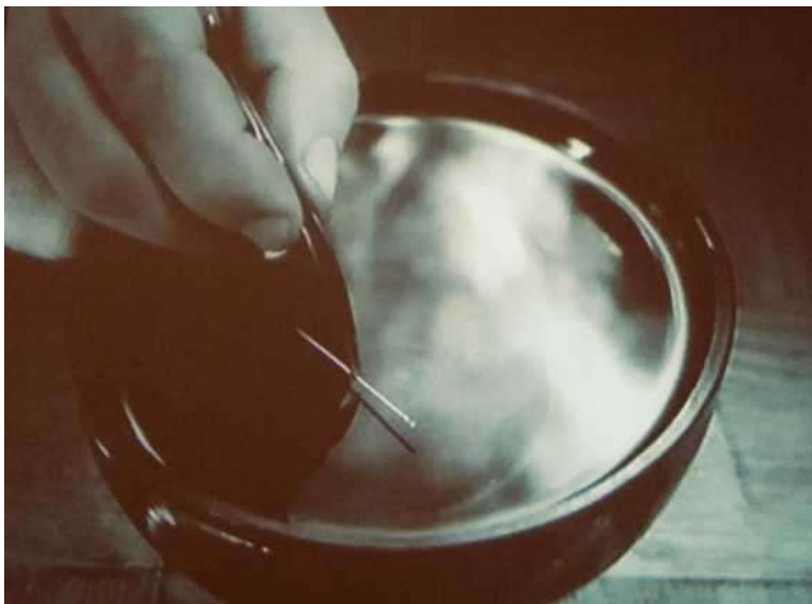
Obrázek 48: Laborant klade jehlu na hladinu a demonstruje tak povrchové napětí kapaliny. Z filmu Povrchové napětí (1949)
