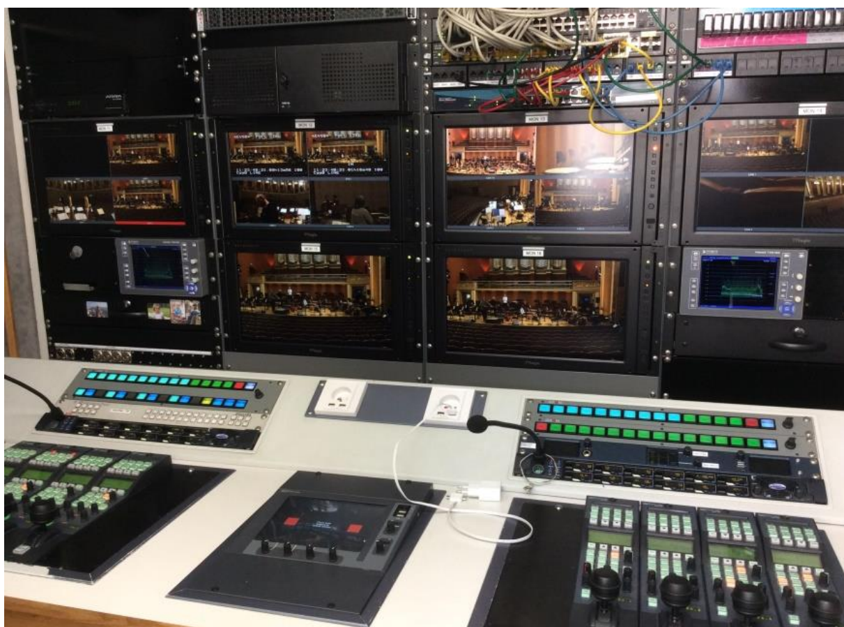
Obrázek 39: Pracoviště obrazové kontroly v přenosovém voze. V porovnání s technikou televizního studia se prakticky neliší. Nižší je jen komfort obsluhy ve stísněných prostorách.
