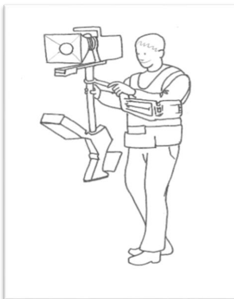
Obrázek 34: Schematický obrázek stabilizačního zařízení steadicam s operátorem
