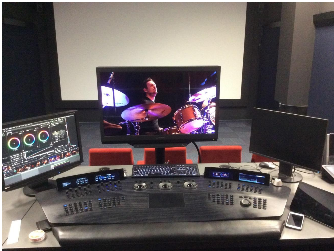
Obrázek 15 Pracoviště pro korekci obrazu s ovládací konzolí a s možností projekce na plátno datovým projektoem – pro výrobu projektu určeného pro kinodistribuci. V tomto konkrétním případě je korigován televizní pořad. Upravovaný obraz se zobrazuje na kalibrovaném monitoru.
