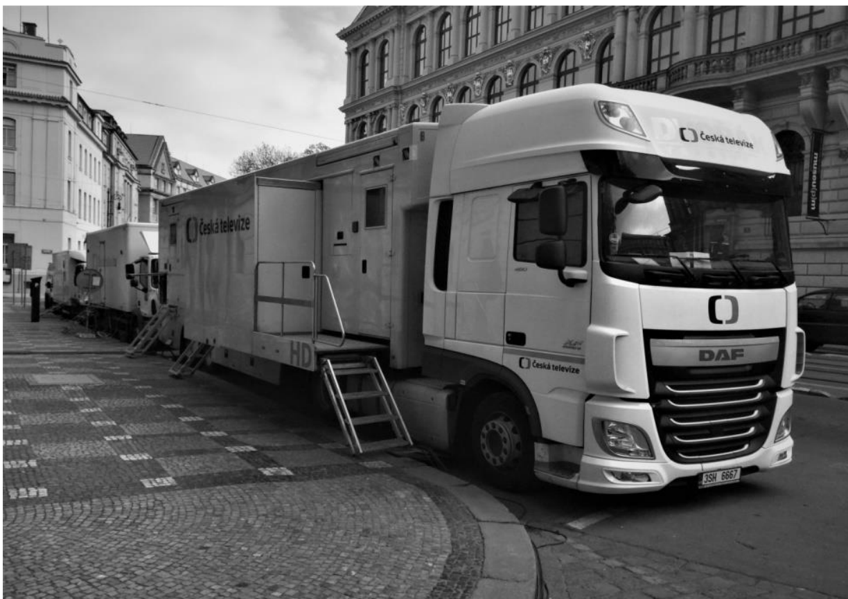
Obrázek 38 Jeden z flotily přenosových vozů České televize zachycený rovněž před Rudolfinem. V nástavbě kamionu je koncentrovaná veškerá technologie - pojízdná studiová režie s kompletním vybavením. Vozy v pozadí jsou pomocné a jsou určeny pro převoz kamer s příslušenstvím a jako zázemí pro posádku.
