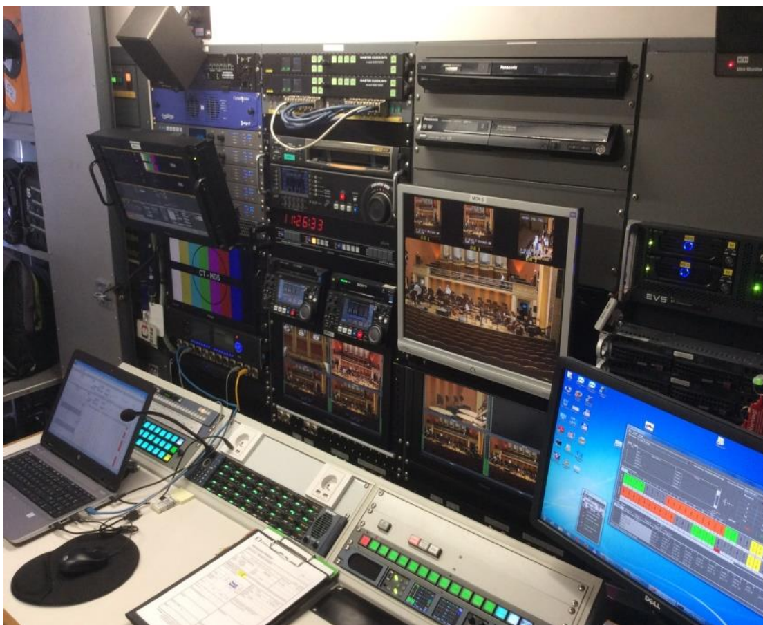
Obrázek 40: Záznamové pracoviště v přenosovém voze, z fotografie je patrná kompaktnost celého zařízení
