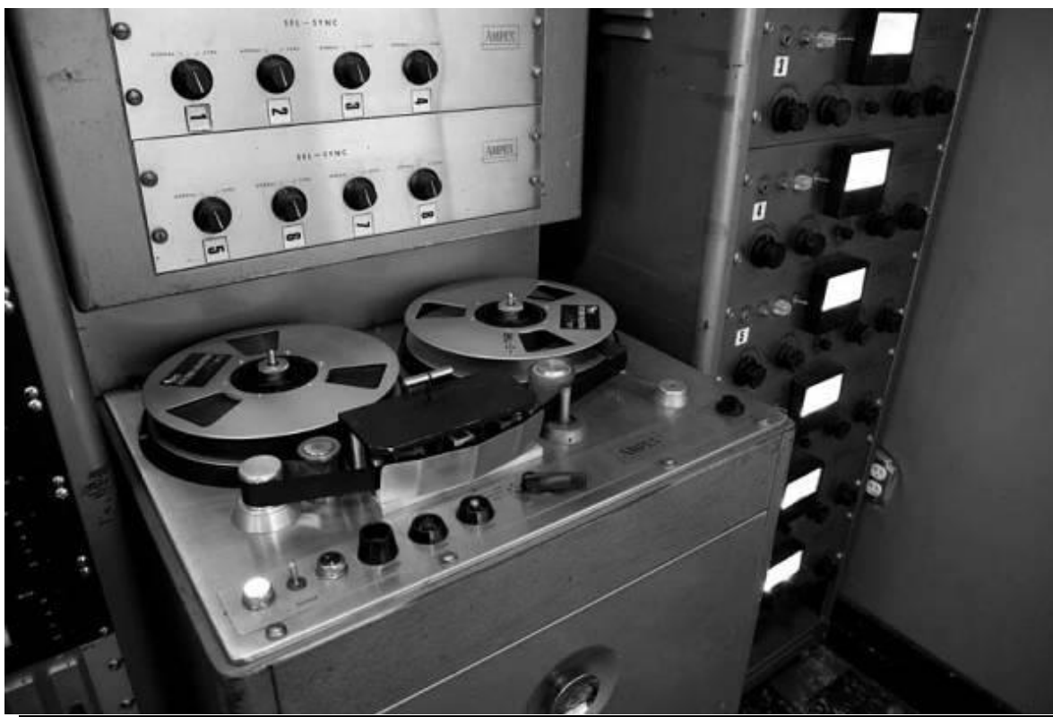
Obrázek 22: Jeden z prvních videozáznamů - výrobce: firma AMPEX. Všechny složky obrazu se zaznamenávaly na dvoupalcový magnetický pás.
