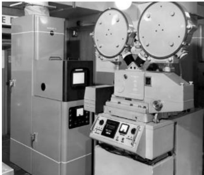
Obrázek 17 Soustava systému TRC - filmový projektor a televizní snímací zařízení. Obraz z filmového pásu je promítán rovnou do objektivu televizní kamery
