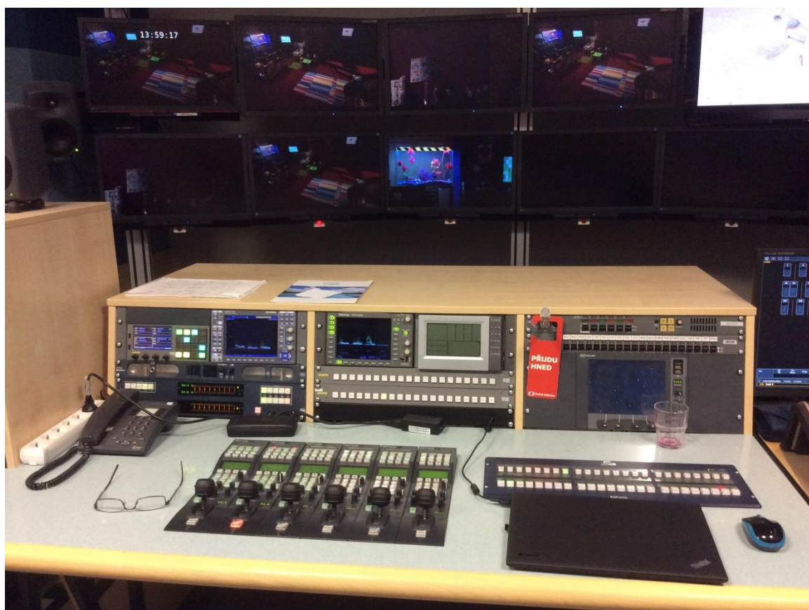
Obrázek 30: Pracoviště pro korekci obrazu v televizním studiu. Obraz je korigován jednak na základě subjektivního vizuálního vjemu, tak na základě exaktně měřených fyzikálních parametrů.
