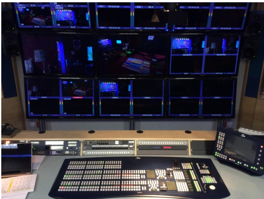
Obrázek 26 Pracoviště obrazového stříhače v televizním studiu - monitorová stěna a stříhový pult.
