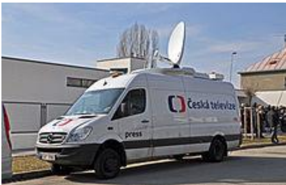
Obrázek 42 Kompaktní přenosový vůz pro satelitní přenos signálu. Je vybaven vlastními kamerami a velmi kompaktní režií. Je využíván pro zpravodajské účely. Lze jej také připojit k "velkému" vozu. Slouží pak primárně pro přenos signálu.
