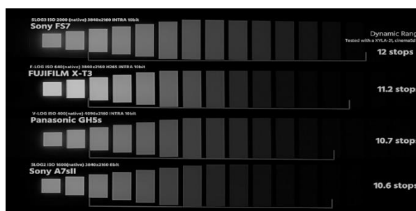
Obrázok 31: dynamický rozsah pre rôzne typy kamier a rôzne bit. hĺbky
