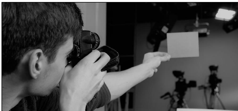
Obrázok 34: spotmeter využívame na meranie osvetlenia referenčnej plochy v presne vymedzenom uhle a smere. Vieme ním merať napríklad svetelný pomer na scéne.
