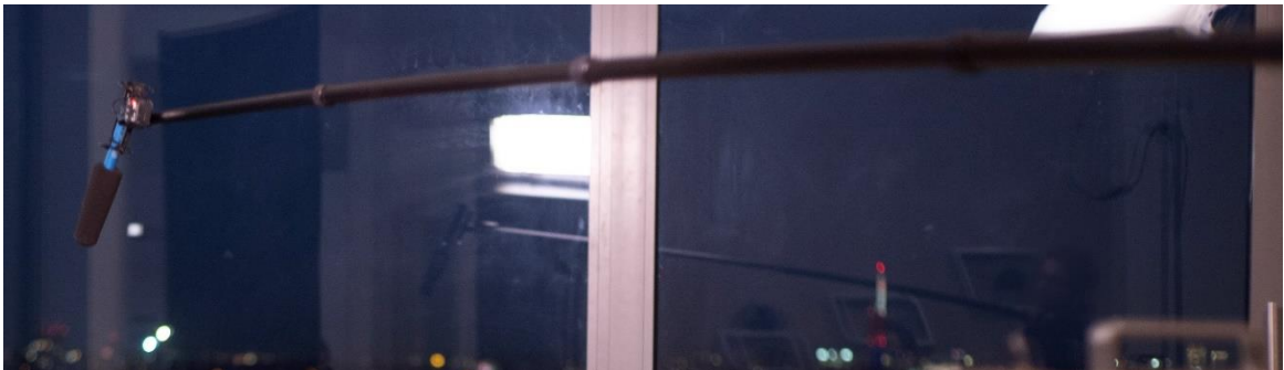
Obrázek 3-20: Shotgun mikrofon na boom pole
