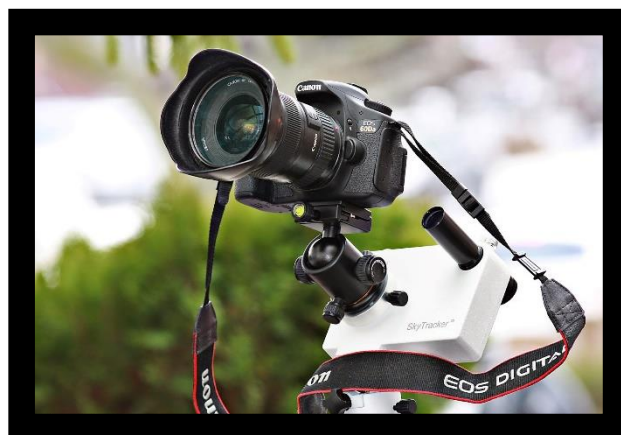
Obrázek 19: Vlevo je technické provedení „na zádech“, které využívá k pohybu fotoaparátu montáž dalekohledu, vpravo je pak samostatná montáž na stativu, která slouží jen k navádění fotoaparátu (korekce denního pohybu) 17
