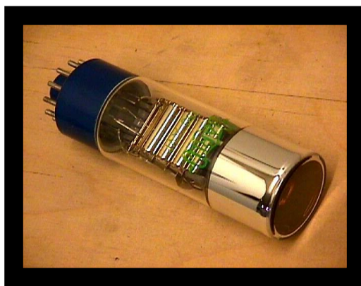
Obrázek 14: Technické řešení trubice fotonásobiče. 13
