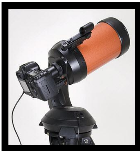
Obrázek 21: Fotoaparát umístěný v ohnisku dalekohledu 19
