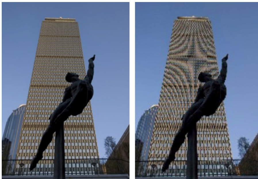
Obrázek 7.3 Použití správné vzorkovací frekvence (vlevo) a aliasing efekt (vpravo) [32].
