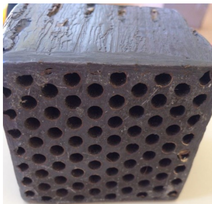
Obrázek 6.7: Ukázka konvergentního (otvory se sbíhají se ke zdroji záření – rozprostře malou plochu objektu na větší plochu detektoru) kolimátoru pro vysoké energie. Tento typ kolimátoru se používal v 60.–70. letech. [Zdroj: vlastní].
