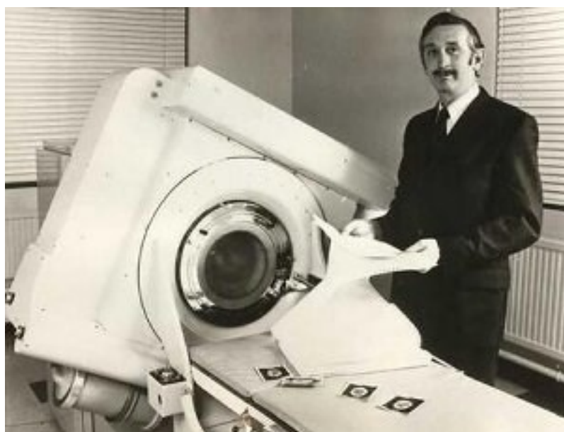
Obrázek 5.2: První klinicky použitelný CT skener – hlavový EMI Mark I zkonstruovaný na základech Cormackovy teorie. Vyroben EMI Medical pro fyzika G. N. Hounsfielda, 1972 [60].
