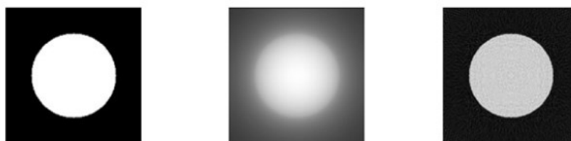
Obrázek 5.7: Vlevo: originální obraz; uprostřed: jednoduchá zpětná projekce; vpravo: filtrovaná zpětná projekce.
