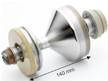
Obrázek 4.14: Rentgenkou s rotační evakuovanou baňkou STRATON (firma Siemens) používaná u CT zařízení. Rentgenka umožňuje chlazení až 4,8 MHU/min, čímž se výrazně redukuje čekací čas na zchlazení rentgenky v průběhu náročnějších výkonů. Rentgenka je schopná zchladit se na teplotu okolního oleje za dobu přibližně 20 s. Svazek elektronů fokusován a kontrolován magnetickým polem [19].
